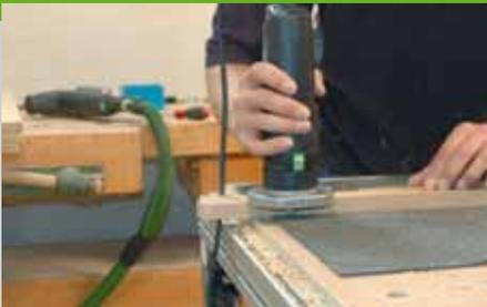
5. An den Querleisten (Pos. 2) werden die Rasterungen für die Höhenverstellung mit einer Handsäge oder einer Stichsäge ausgeschnitten. Runden Sie jetzt alle Leisten der Tischplatte (Pos. 1). Legen Sie dann die Leisten mit der Oberseite nach unten auf eine rechtwinklige Unterlage und schieben Sie diese zusammen. Eine Querleiste (Pos. 2) wird auf einer Seite bündig aufgelegt und mit einem Meterstab wird
