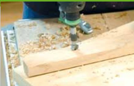
2. Mit einem Kegelsenker werden die 8 mm Bohrlöcher auf beiden Seiten ausgerieben. Zeichnen Sie dann die Mittelpunkte der 20 mm Löcher an. Beim Bohren der beiden Löcher für die Rastpunkte der Höhenverstellung sollten Sie, um Ausrisse zu verhindern, entweder von beiden Seiten bis zur Hälfte
