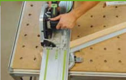
1. Schneiden Sie die Leisten auf das in der Materialliste angegebene Maß zu. Bei Schnitten quer zur Faser, sollte man ein feines Sägeblatt (Vielzahn- bzw. Furniersägeblatt) benutzen. Die Aussteifung für das Untergestell (Pos. 6)
