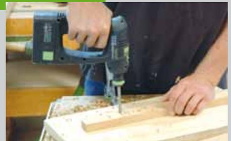
gebohrt. Zeichnen Sie die genauen Positionen der Löcher an. Beim Bohren der Löcher sollten Sie ein Abfallholz unterlegen, um Ausrisse am Bohrloch zu verhindern.
