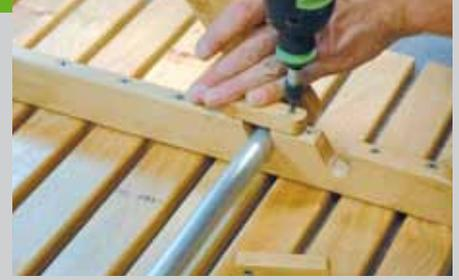
legen Sie unter die Muttern Federringe, um einem selbstständigen Lösen der Muttern vorzubeugen. Um den Tisch auch tragen zu können, müssen zwei Holzklötze (Pos. 9) als Sicherungen unter die beiden Rasterungen geschraubt werden. Diese Klötze werden jeweils nach vorne oder hinten gedreht und verhindern, dass das Aluminiumrohr aus der Rasterung herausrutschen kann.
