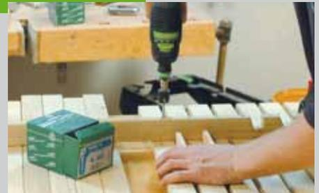
Legen Sie alle Leisten zusammen und zeichnen Sie den Abstand der Querleisten von Außen ein. Schrauben Sie zunächst die erste und die letzte Leiste fest. Legen Sie dann die anderen Leisten nach und nach mit den Abstandsklötzen dazwischen ein, bohren 4,5 mm Löcher in den Querleisten vor und schrauben Sie die Leisten mit Spax 4 x 60 fest.
