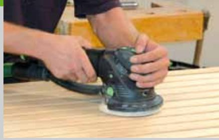
Körnung P 240 geschliffen. Danach werden noch ein bis zwei weitere Ölschichten mit einem Lappen aufgetragen. Zum Verschrauben der Gestellteile werden Edelstahl- oder Messing-Schlossschrauben, bzw. Maschinenschrauben verwendet. An den Stellen, wo die Mutter das Holz berührt und zwischen den beiden beweglichen Teilen des Untergestells, werden Scheiben unterlegt. Benutzen Sie Sicherungsmuttern oder
