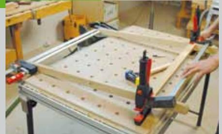
Kleben Sie zunächst in beiden Beinen das Aluminiumrohr ein und verkleben Sie anschließend die untere Strebe. Verspannen Sie alles mit Zwingen. Das zweite Gestellteil wird auf die gleiche Art und Weise verklebt.
