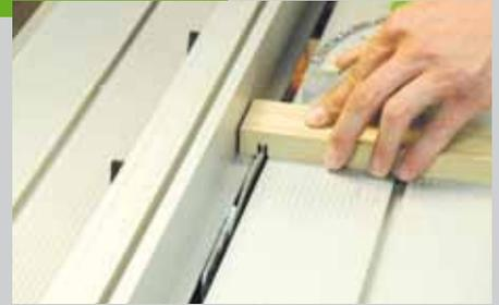
und dann mit der Tauchsäge mit mehreren Schnitten die Verbindung herausgesägt. Auch bei den Ausschnitten an den Streben können Sie die beiden zuvor genannten Arbeitsweisen anwenden oder Sie benutzen wie gezeigt eine Tischkreissäge.
