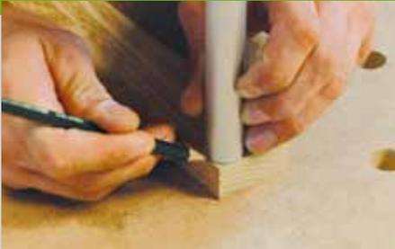
4. Die Querleisten unter der Platte (Pos. 2) und die Beine (Pos. 3 + 4) werden an den Ecken jeweils abgerundet. Zeichnen Sie dazu mit einem runden Gegenstand oder einem Zirkel die Rundungen an. Mit einer Stichsäge und einem feinem Kurvensägeblatt werden die Rundungen ausgesägt.
