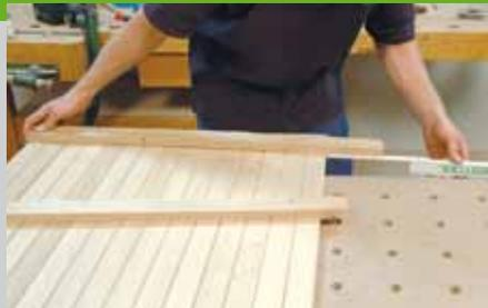
der Überstand gemessen. Teilen Sie dieses Maß durch die Anzahl der Leistenzwischenräume. Das Ergebnis ist das genaue Maß des Zwischenraumes zwischen den Leisten der Platte. Schneiden Sie Abstandsklötze mit diesem Maß zu die beim Verschrauben der Platte benutzt werden. Spannen Sie die erste Leiste mit einer Längskante und einer Querkante bündig an der Außenkante der Unterlage fest.
