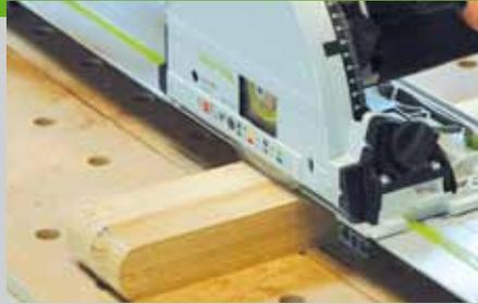
und Schiene arbeiten oder eine Tischkreissäge benutzen. Beim Arbeiten mit den Handwerkzeugen, wird zunächst am Strich entlang nach unten gesägt und dann der Zwischenraum mit einem Stemmeisen herausgearbeitet. Beim Arbeiten mit Tauchsäge und Schiene werden die Leisten zusammengespannt
