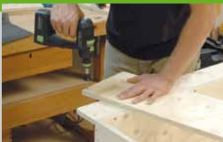
2. Bohren Sie jeweils in einem der beiden Bretter, die miteinander verbunden werden sollen, Löcher (D = 4,5) für die Spax-Schrauben (4 x 45). Bohren Sie in die Pos. 16 jeweils 4 Löcher und benutzen Sie diese als Verbindungs-laschen beim Verschrauben von Pos. 1 + 2. Dadurch erhalten Sie eine
