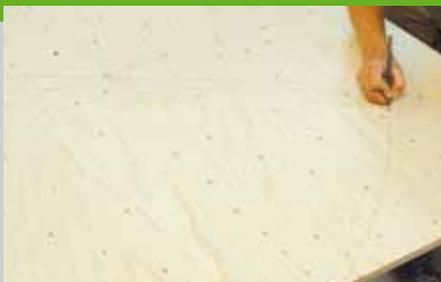
1. Zeichnen Sie sich mit Hilfe einer Schnur, die als Zirkel dient, im angegebenen Radius die beiden Außenrundungen an einer Deckplatte (Pos. 1) an. Zunächst wird die Breite der Deckplatte auf der Platte angezeichnet. Markieren Sie dann auf der Vorderseite den Mittelpunkt und zeichnen Sie den Ausschnitt für Kopf und Schweif ein. Schlagen Sie in den ersten Mittelpunkt
