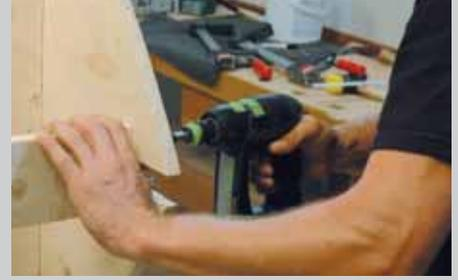
Richten Sie die beiden Befestigungsplatten für Kopf und Schweif (Pos. 10) zwischen Deck und Bodenplatte aus und schrauben Sie beide fest.
