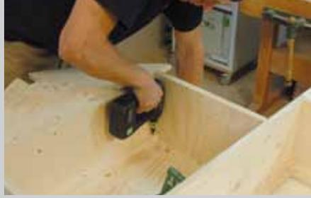
Schneiden Sie diese Leisten auf das in der Materialliste angegebene Maß ab. Sie werden jeweils längs in den Sandkasten und quer an Front und Heckaussteifung geschraubt.
