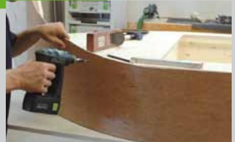
Boot und zeichnen Sie die Positionen der Schrauben an. Die ersten beiden Platten festschrauben. Wenn Sie die anderen beiden Platten festschrauben, werden Sie merken, dass es in der Mitte zu einer Überlappung kommt. Zeichnen Sie diesen Überstand auf der befestigten Platte an und lösen Sie diese soweit, dass ein Stück vom Boot absteht. Schneiden Sie jetzt mit der Stichsäge oder hobeln Sie mit dem Handhobel diese Überlänge ab.
