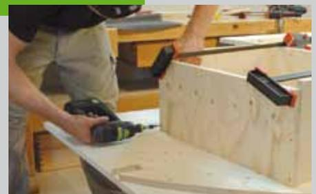
Verspannen Sie die beiden Längsstreben (Pos. 5) und die Aussteifung mit dem Sandkasten und verschrauben Sie alles.
