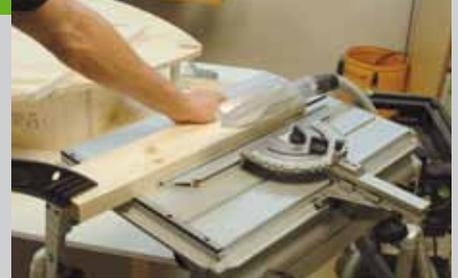
und Schwanz schnitzen. Die vier Befestigungsleisten (Pos. 11) werden mit einer Tischkreissäge schräg (30 Grad) geschnitten. Schneiden Sie diese Leisten auf das angegebene Maß ab.
