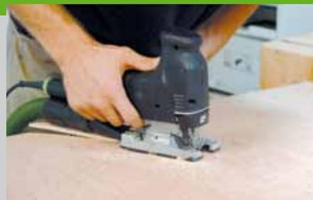
einen Nagel ein und befestigen Sie daran die Schnur. In eine Schlaufe auf der anderen Seite der Schnur wird ein Bleistift eingesteckt. Zeichnen Sie zunächst beide Rundungen einer Deckplatte an, schneiden Sie diese aus und übertragen Sie dann die Kontur auf die andere Deckplatte und auf die Bodenplatten (Pos. 6). Schneiden Sie auch diese drei Teile mit der Stichsäge
