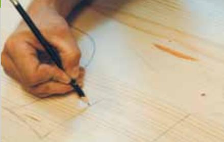
4. Um den Drachenkopf größer gestalten zu können, wird ein Rest der Baubohle als Schnauze angeleimt. Zeichnen Sie die Form von Kopf und Schwanz mit einem Bleistift auf. Schneiden Sie die Konturen dann mit der Stichsäge aus. Benutzen Sie ein Kurvensägeblatt und sägen Sie langsam. Dadurch ersparen
