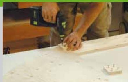
zusammenhängende Deckplatte. Verschrauben Sie dann die vier Seiten des Sandkastens miteinander. Die beiden seitlichen Bodenplatten (Pos. 6) werden mit dem Kasten verschraubt. Richten Sie den Kasten auf der Unterseite der Deckplatte aus und markieren Sie die genaue Position mit ein paar Strichen.
