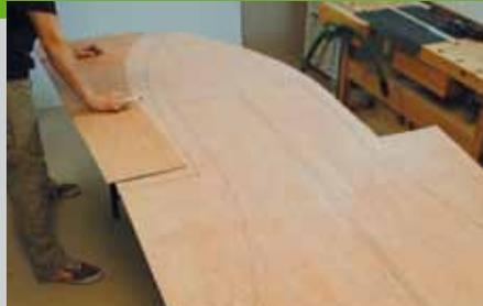
Sperrholzplatte. Bei der Länge müssen Sie 10 mm dazugeben. Der Schwung wird freihändig mit einem Bleistift aufgezeichnet. Schneiden Sie die erste Beplankung aus und benutzen Sie diese als Schablone zum Aufzeichnen der anderen drei. Entgraten Sie alle Kanten mit einem Handschleifklotz. Die Kante, die an Kopf und Schweif stößt, wird mit einem Handhobel auf 30 Grad schräg gehobelt. Halten Sie die erste Sperrholzplatte ans
