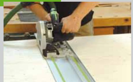
aus und entgraten Sie die Schnittkanten mit einem Handschleifklotz. Die geraden Platten werden mit einer Handkreissäge und einer Führungsschiene zugeschnitten. Alternativ können Sie gerade Einzelteile auch im Baumarkt zuschneiden lassen.
