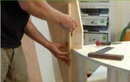
5. Schrauben Sie Kopf und Schweif am Schiffsrumpf fest. Zeichnen Sie senkrecht die Kante an, an der die Befestigungsleisten angeschraubt werden. Schrauben Sie die vier Leisten fest. Zeichnen Sie sich auf der seitlichen Deckplatte den Mittelstrich an, an dem die Beplankung zusammenstößt. Messen Sie von diesem Mittelstrich aus bis zu Kopf und Schweif die Länge der einzelnen Beplankungsplatten. Übertragen Sie die Maße auf die 6 mm
