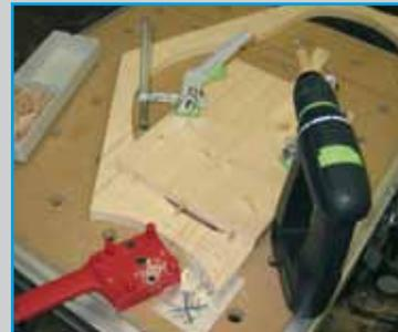
**6** Zusammenlegen der einzelnen Krippenteile und übertragen der Dübellöcher auf die angezeichnete Mittellinie. Alternativ die Dübellöcher mit Dübelspitzen übertragen. Dübel (Pos.8)
