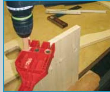
**5** Bohren der Dübellöcher ( $\varnothing$  6 mm) im Querholz der Seitenwände mit Hilfe einer Dübelschablone
