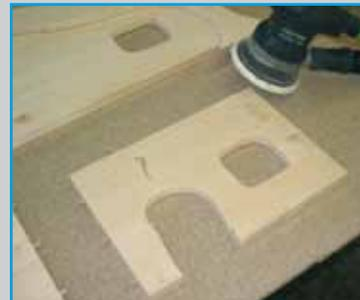
**7** Die einzelnen Kanten schleifen und mit Hilfe einer Oberfräse oder von Hand abrunden. Schleifen der Flächen mit einem Exzentrerschleifer oder von Hand.
