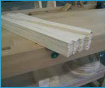
**9** Während der Leim trocknet, die Dachleisten (Meterware im Holz-handel) fürs Dach auf Länge schneiden und die Kanten brechen.
