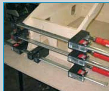
**8** Mit Zwingen und Zulagen oder mit Spezialzwingen (z. B. Korpuszwingen) verspannen. An der Türe zwei Zwingen ansetzen (siehe Bild)
