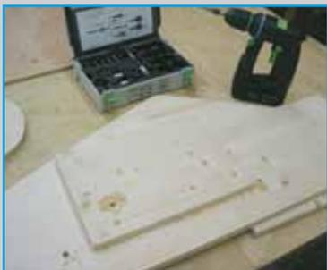
**4** Die geschnittenen Teile zusammensetzen, ausrichten und die spätere Position der Aussenwände anzeichnen.
