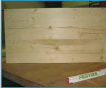
**1** Festschrauben der Aufdopplung unter die Grundplatte (Spax 3,5 x 35 (Pos. 6))
