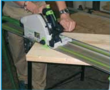
**2** Anzeichnen der Aussenkanten der Seitenteile. Ausschneiden der geraden Schnitte mit einer Handkreissäge und Führungsschiene oder mit einer Stichsäge.
