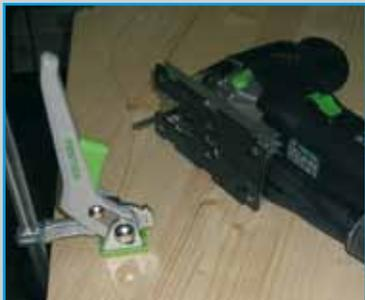
**3** Ausschneiden der geschwungenen Teile mit einer Stichsäge. Um die Fenster ausschneiden zu können, zunächst in den Ecken ein Loch ( $\varnothing$  8 mm) bohren.
