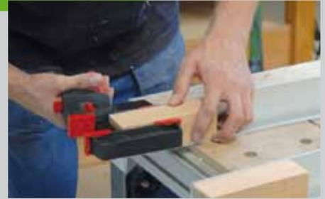
Kleber im Rahmen getrocknet ist, werden die Zwingen gelöst und die Verbindungen mit einem Exzentrerschleifer und Schleifpapier Körnung P 120 eben geschliffen. Die Oberkante des Rahmens wird entweder mit einer Kreissäge oder einem Handhobel abgeschragt.
