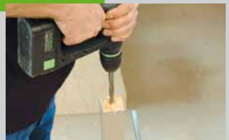
Die Bohrtiefe entspricht der Länge der Maschinenschraube. Der Bohrdurchmesser hängt von der Muffenart und vom Hersteller ab. Wenn Sie die leichter zu verarbeitenden Einschlagmuffen verwenden, sollten Sie diese nach dem Einschlagen zweimal durchbohren und mit Spax-Schrauben 3,5 x 35 gegen Herausrutschen sichern.
