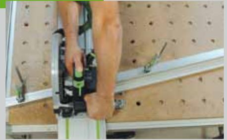
aber auf jeden Fall das passende Sägeblatt (Universal- oder Aluverzahnung) verwendet und die Drehzahl reduziert werden. **Wichtig:** Tragen Sie eine Schutzbrille, um Ihre Augen vor Aluminiumspänen zu schützen.
