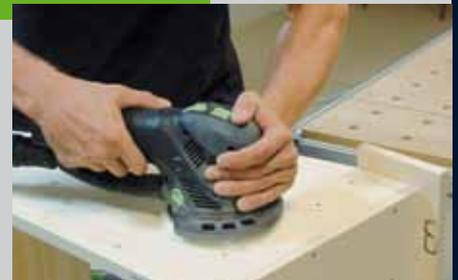
An diesen Ring kommt eine Kette, mit der der Alustab an der Klappe oder am Kasten befestigt wird. Zur Oberflächenbehandlung sollten Sie das Beet wieder zerlegen und mit einem Exzenter schleifer schleifen, letzter Schliff Körnung P 180. Lasieren Sie den Kasten und Rahmen farbig und die Massivholzteile transparent.
