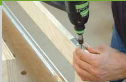
mit einem Vorstecher vor und schrauben Sie die Spax-Schrauben 3,5 x 25 mm ein. Befestigen Sie mit 50 mm Abstand von den Ecken und an der Unterseite die beiden Scharniere bündig an der Klappe. Das Vorstechen der Schraubenlöcher hilft die Schraube mittig im Befestigungsloch zu positionieren, so dass das Scharnier beim Festschrauben nicht auf eine Seite
