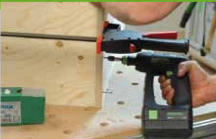
2. Bohren Sie in Front- und Rückwand (Pos. 1 + 2) Löcher  $D = 3,5$  mm für die Spax-Schrauben ( $3,5 \times 35$ ) vor. Die vier Bretter, die den Kasten bilden, werden mit Zwingen zusammengespannt, ausgerichtet und miteinander verschraubt.
