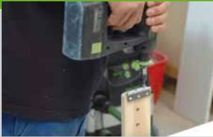
7. Bohren Sie in den Verschluss (Pos. 7) die Löcher (8 mm) für die Höhenverstellung der Klappe. Senken Sie die Löcher großzügig mit einem Kegelsenker. Positionieren Sie auf der oberen Schmalfläche des Verschlusses das Scharnier und richten Sie es mittig mit der langen Kante bündig an der Verschlusskante aus. Stechen Sie die Schraubenlöcher
