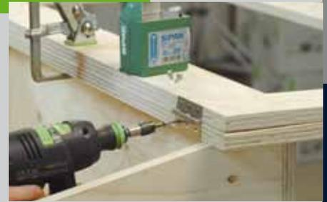
verrutscht. Legen Sie die Klappe mit der Oberseite nach unten auf die Ablage, richten diese an den Seiten bündig aus und spannen sie fest. Mit Spax-Schrauben werden Klappe und Kasten miteinander verbunden. Bohren Sie in den Beinen (Pos. 14 + 15) Schraubenlöcher (D = 3,5 mm) vor und schrauben Sie die Beine am Kasten fest.
