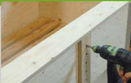
8. Schrauben Sie den Verschluss mittig am Klapprahmen fest und bohren Sie das obere Loch mit einem 8 mm Bohrer bis in den Kasteninnenraum. Die Kanten der Acrylglasplatte werden mit einer Zieh Klinge oder Schleifpapier entgratet. Zeichnen Sie die Bohrlöcher auf der Schutzfolie an und bohren Sie sie mit einem 3,5 mm Holzbohrer mit Zentrierspitze. Senken Sie die Löcher mit einem
