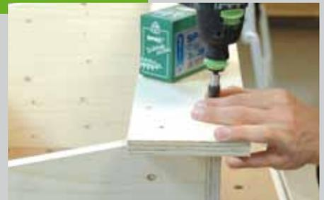
Zeichnen Sie den Überstand des Brettes unter der Ablage an, richten Sie das Brett auf dem Kasten aus und schrauben Sie es fest.
