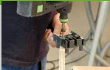
nen Rahmenteile mit Hilfe des Schreinerdreiecks (Infos zur Schablone und zum Schreinerdreieck unter [www.Kurswerkstatt.de](http://www.Kurswerkstatt.de)). Bohren Sie zunächst in die kurzen Schmalfächen der Rahmenschengel (Pos. 6) jeweils zwei  $8$  mm Dübellöcher (Bohrtiefe halbe Dübellänge +  $1$  mm). Die Löcher sollten vom Rand
