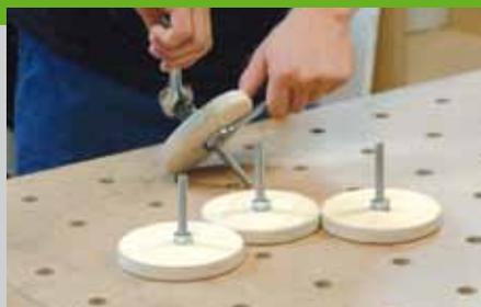
Bohren Sie dann das 10 mm Durchgangsloch für die Schrauben. Auf die Gegenseite kommen zunächst eine Beilagscheibe und eine Mutter. Ziehen Sie die Mutter mit einem Ring- oder Gabelschlüssel fest an. In den Beinen werden als Gegengewinde zu den Scheiben Einschraub- oder Einschlagmuffen eingebohrt.
