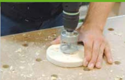
6. Für die einstellbaren Füße werden runde Scheiben (Pos. 16) aus Sperrholz mit einer Stichsäge ausgeschnitten. Brechen (entgraten) Sie die Kanten mit einem Handschleifklotz. Auf der Unterseite der Scheiben werden 30 mm Löcher gebohrt, die Bohrtiefe entspricht dem Kopf der Maschinenschraube (M 10 x 80) und einer Beilagscheibe.
