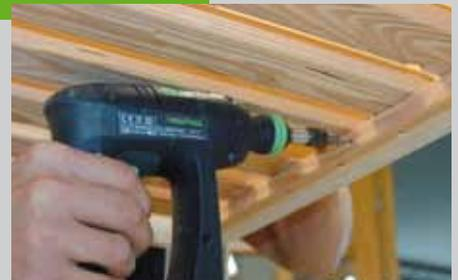
Der obere Rost wird auf die gleiche Art gebaut. Wichtig ist hier, dass die beiden Außenleisten um das Abstandsmaß nach innen versetzt werden. Bohren Sie dann in die Auflageleisten des oberen Rostes 3,5 mm Löcher und schrauben Sie den Rost am Kasten fest.
