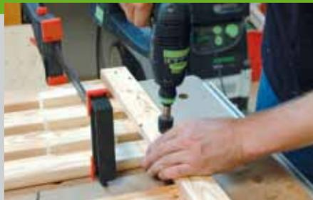
der Abstände (7) geteilt. So erhalten Sie das genaue Abstandsmaß. Schneiden Sie sich eine Leiste mit diesem Maß zu und legen Sie diese beim Verschrauben als Abstandhalter dazwischen. Um rationaler zu arbeiten, können Sie mehrere Leisten mit Abstandsklötzen dazwischen miteinander verspannen, vorbohren und verschrauben.
