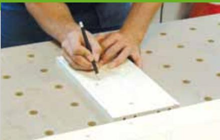
3. Die vier Teile für den Klapprahmen werden mit Dübeln verbunden. Wenn möglich sollten Sie Dübel ( $8$  mm  $\times$   $40$  mm) aus wasserfestem Holz (Eiche, Sipo) verwenden. Die Löcher für die Dübelverbindung werden mit einer einfachen Schablone gebohrt. Kennzeichnen Sie die Positionen der einzel-
