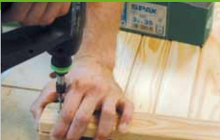
5. Legen Sie die Leisten (Pos. 9) des unteren Rostes zusammen. Bohren Sie die vier Löcher zum Befestigen der ersten und letzten Leiste in der Auflageleiste vor. Schrauben Sie die beiden Leisten bündig mit den Außenecken fest. Dann schieben Sie alle Leisten zusammen und messen den Abstand zur äußeren Leiste. Dieses Maß wird durch die Anzahl
