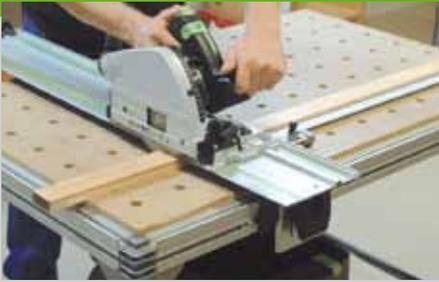
1. Schneiden Sie die einzelnen Bretter und Leisten auf die in der Materialliste angegebenen Maße zu. Auf den beiden Seiten (Pos. 3) wird die schräge Kante angezeichnet und mit Hilfe der Handkreissäge mit Führungsschiene zugeschnitten.
