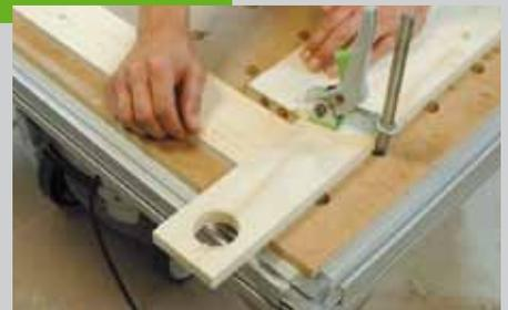
ca.  $10$  mm entfernt und möglichst in der Mitte der Platte sein. Stecken Sie Dübelspitzen in die Löcher und übertragen Sie damit die Mittelpunkte auf die langen Rahmenschengel (Pos. 5). Das auf dem Tisch gespannte Brett dient als Anschlag. Bohren Sie auch hier die Löcher mit der gleichen Bohrtiefe.
