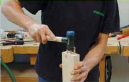
4. Geben Sie PU-Kleber in die Dübellöcher der kurzen Rahmenschenkel und schlagen Sie die Dübel ein. Geben Sie dann in die Gegenlöcher Kleber und stecken Sie die Rahmenteile zusammen. Der Rahmen wird mit Zwingen verspannt. Mit den Zwingen, die senkrecht auf den Klebe-
