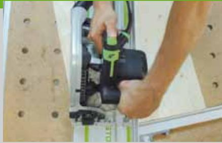
Mit dem auf dem im Bild gezeigten Multifunktionsstisch können Sie die Anschlagschiene schräg stellen und das Werkstück am Tisch fest spannen. So lassen sich auch die Aluminiumprofile für die Beine zuschneiden. Hierbei sollte
